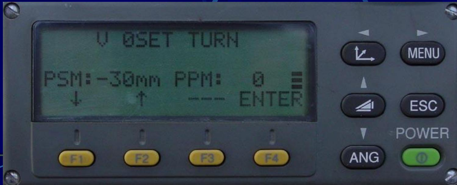
3. 全站仪的垂直度盘上装有电子基准，上下转动望远镜，当传感器通过该基准时，仪器自动设置垂直角为 $90^{\circ} 00' 00''$ ，并发出轻微的声音，同时进入角度测量程序，随着仪器的转动，同步显示水平角与垂直角的数值。开机位置的垂直角数值为 $0^{\circ} 00' 00''$ 。
