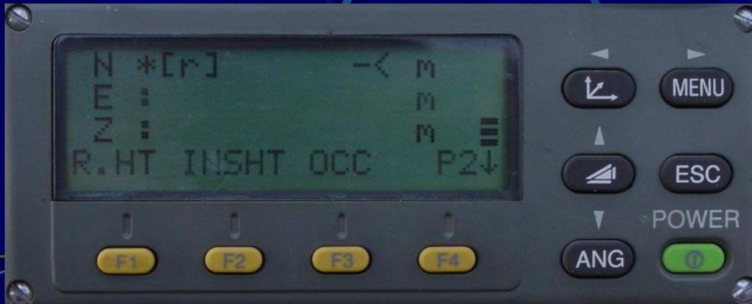
6. 进行测量时，首先需要设置已知点的方向角（照准已知点，设置其水平角），再照准未知点上的棱镜，按压坐标测量模式[ ]键开始工作，显示窗将显示测量结果，即棱镜点的三维坐标（N、E、Z）。测量下一个控制点的坐标时，瞄准好棱镜中心后，按压[F1]即可。
