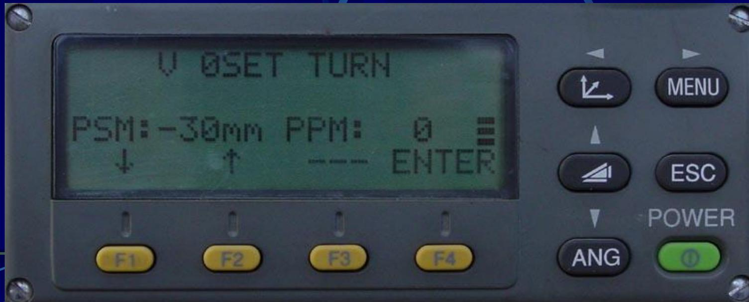
3. 全站仪的垂直度盘上装有电子基准，上下转动望远镜，当传感器通过该基准时，仪器自动设置垂直角为 $90^{\circ} 00' 00''$ ，并发出轻微的声音，同时进入角度测量程序，随着仪器的转动，同步显示水平角与垂直角的数值。
